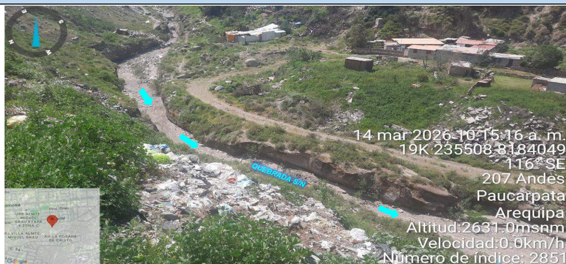
Imagen N° 1. Tramo colmatado en el sector Miguel Grau 2, en donde se observa sedimentación en el cauce de la quebrada S/N.
