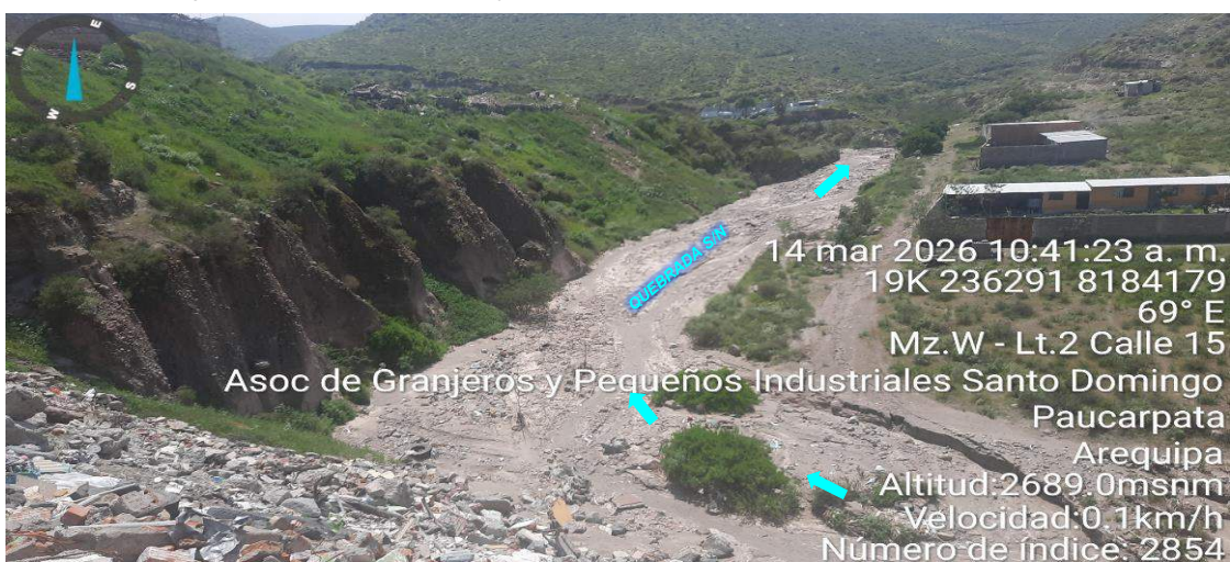
Imagen N° 2. Zona colmatada en el tramo, en donde se observa sedimentación en el cauce de la quebrada S/N.
